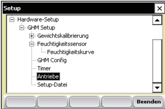
**Abbildung 3-23: Tippen Sie zweimal im Setup-Menü auf “Antriebe”, um zum Bildschirm “Aktuator-Setup” zu gelangen.**
