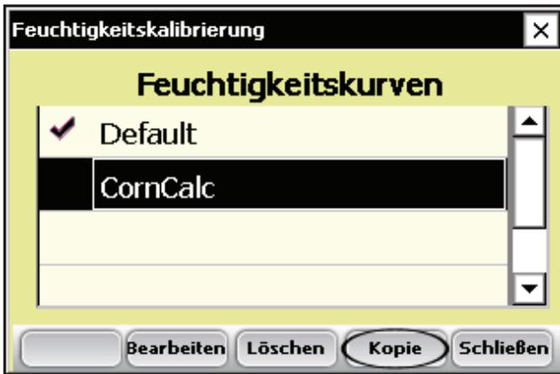
*Abbildung 3-20: Kopieren Sie eine Feuchtigkeitskurve, indem Sie diese auswählen und auf "Kopieren" (F4) tippen.*
