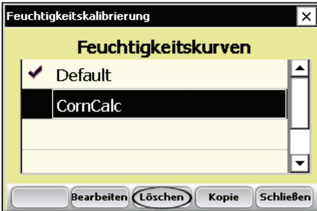
**Abbildung 3-18: Löschen Sie eine Feuchtigkeitskurve, indem Sie diese auswählen und auf Löschen (F3) tippen.**
