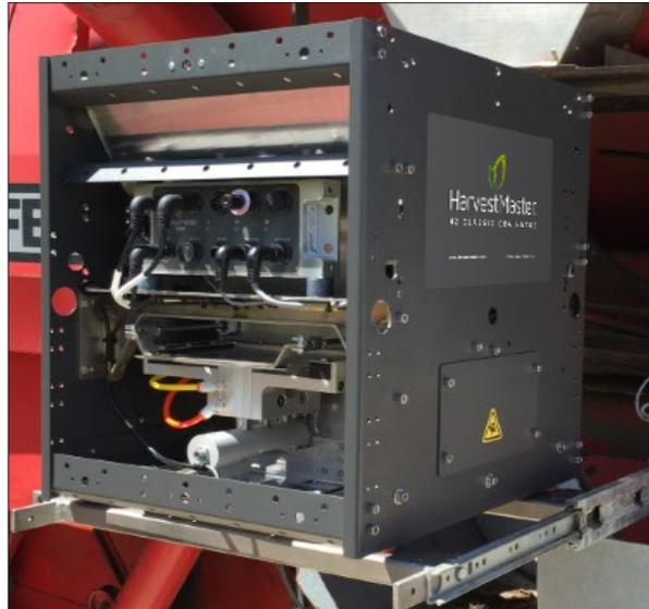
Der H2 Classic GrainGage™ ist konzipiert für Feldversuchsmessungen von Getreide, Bohnen und Ölsaaten und eignet sich für das Arbeiten in einer mobilen Umgebung, wenn er an einem Mähdrescher zum Abernten von Parzellen angebaut ist, oder er kann in Verbindung mit einem stationären Drescher betrieben werden. Er liefert parzellenweise exakte Messdaten über das Gewicht einer gesamten Parzelle, die Feuchte des Ernteguts und das Testgewicht (d.h. Pounds per Bushel).
