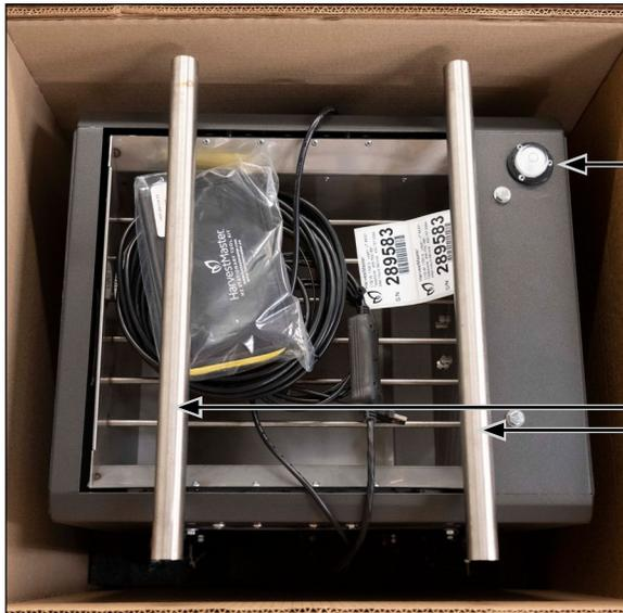
1. Use as pernas dobradas do GrainGage para levantá-lo retirando-o da caixa.
