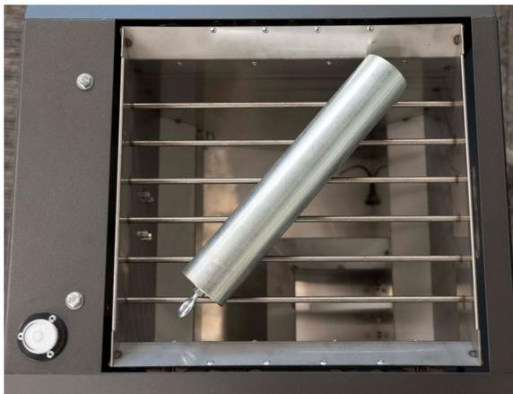
2. Coloque o peso de calibração diagonalmente através da grelha.
