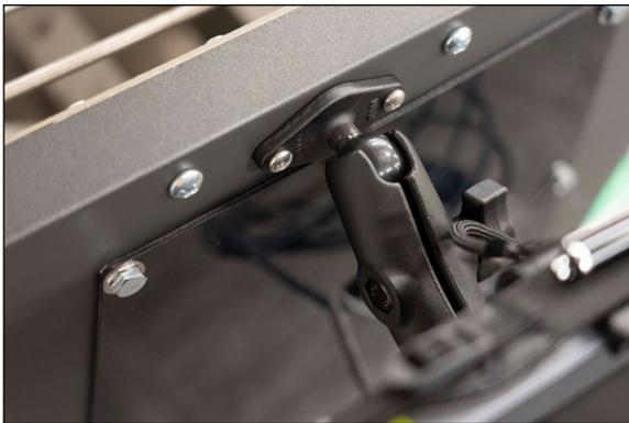
2. Fixe a estrutura do Mesa 3 com o uso dos parafusos de montagem.
