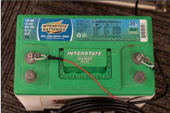
1. Conecte os fios no cabo da bateria aos terminais apropriados em uma bateria de 12 V:
