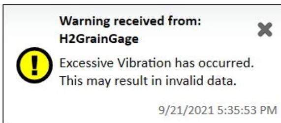
Uma mensagem que você pode ver quando usar o H2 Stationary GrainGage é um aviso de Vibração Excessiva. Isso ocorre se o GrainGage não for colocado em piso firme.
