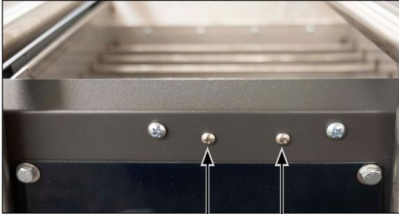
Parafusos de Montagem de Estrutura
