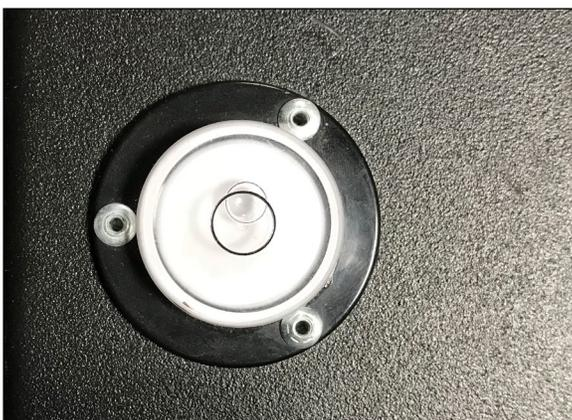
5. Use o nível de bolha no topo do GrainGage para verificar se o GrainGage está nivelado e estável.
