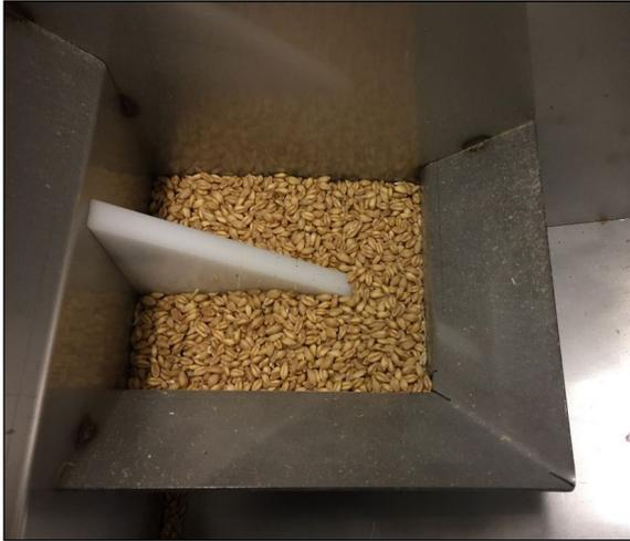
*Nota: HarvestMaster recomenda que a mesma pessoa despeje o grão diretamente sobre a lâmina de umidade da mesma maneira em cada vez. Essa imagem mostra a quantidade mínima de grão necessária para cobrir a lâmina de umidade.*
