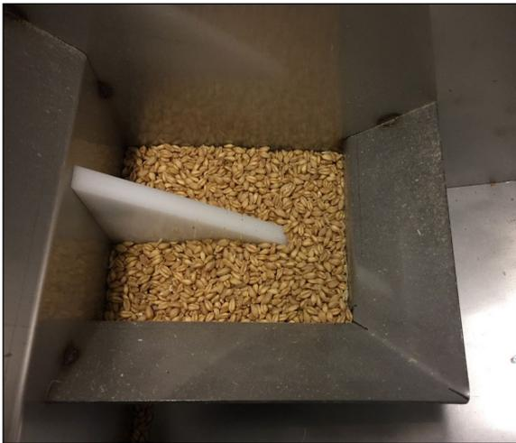
12. Derrame uma amostra de grão no GrainGage diretamente sobre a lâmina de umidade.
