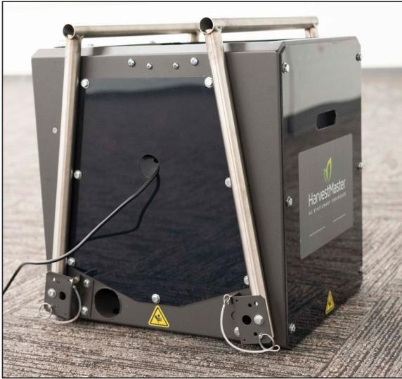
Com as pernas dobradas, o H2 Stationary GrainGage está em posição de transporte ou armazenamento.
