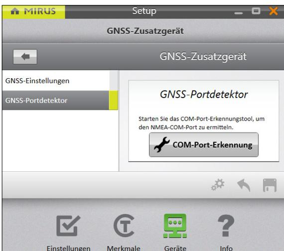
Tippen Sie auf dem Bildschirm **Setup > GNSS-Zusatzgerät**
